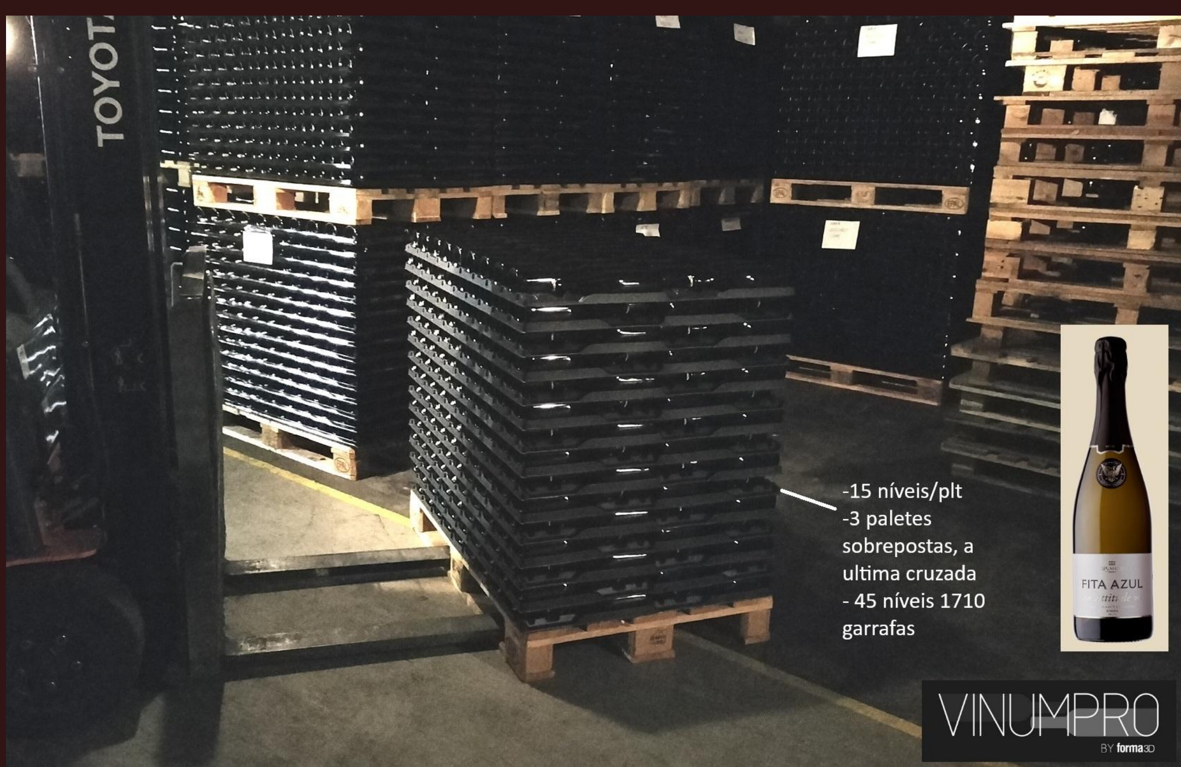
Vinumpro Mod.Nº5 – Botella clásica para vino espumoso, palés de 15 niveles, apilados en 3 palés para un total de 45 niveles. Cada palé contiene 570 botellas.
